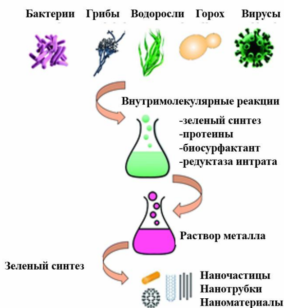
Рисунок 2 – Общая схема получения наночастиц с помощью “Зеленого синтеза” [22]
