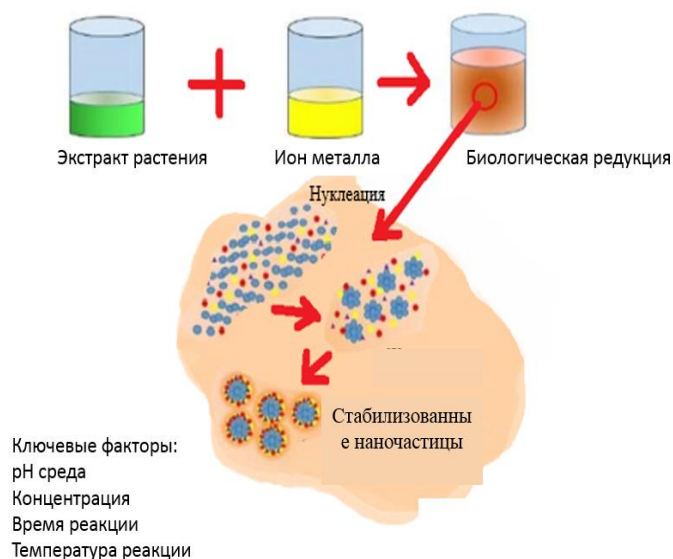
Рисунок 3 – Схема получения наночастиц металлов с использованием растительного экстракта [23]
