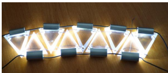
Рисунок 6 - Пример осветительной системы, располагаемой внутри изделия, декорируемого тканью (кожей, кожзаменителями и т.д.) во включенном состоянии
